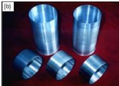
典型喷射成形Al-25Si-Fe-Mn合金的组织 and 缸套毛坯
